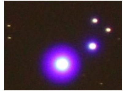
Bild 32: Herausgezoomter Farbsaum eines hellen Sterns vom 4 Zoll Achromat. Wie weit das die Photometrie stört muss ich erst herausfinden (Blende für Himmelshintergrund Messungen...).
