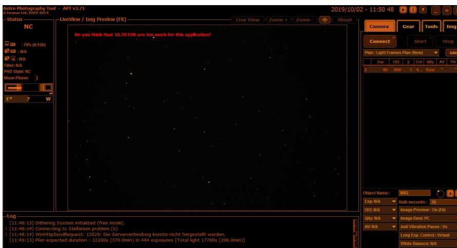
Bild 43: Das Astro Photography Tool (APT) kann Kamera und Teleskop vollständig steuern.
