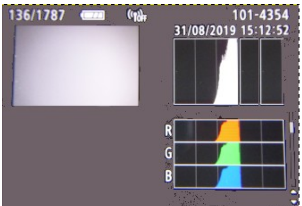
Bild 24: Canon Display mit INFO Button: Das Histogramm ist passend in der Mitte.
