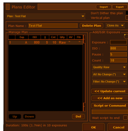
Bild 21: Einstellung von: Exposure, ISO, Pause und Anzahl der Flats.
