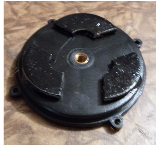
Bild 97: Abhilfe mit einer dicken Beilagscheibe in 3 Teile gesägt, schwarz gestrichen um Reflexionen zu vermeiden und angeklebt. Jetzt haben die Justierschrauben einen Untergrund der nicht nachgibt!
