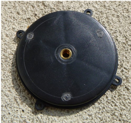
Bild 96: Die Plastikhalterung vom Fangspiegel. Die Justierschrauben haben sich da sehr hineingefressen und erzeugen Spiel. Kein Wunder das die Justierung nie lange gehalten hat!
