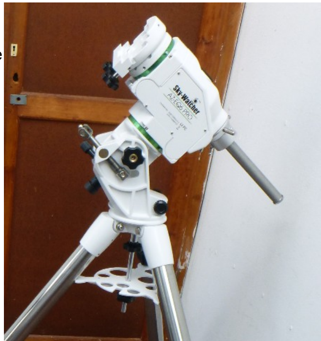
Bild 13: AZ-EQ6-Pro mit einer Nachführgenauigkeit von 0,14 Bogensekunden dank Riemenantrieb. Die Max. Zuladung von 20 kg ist eine eher konservative Angabe.
