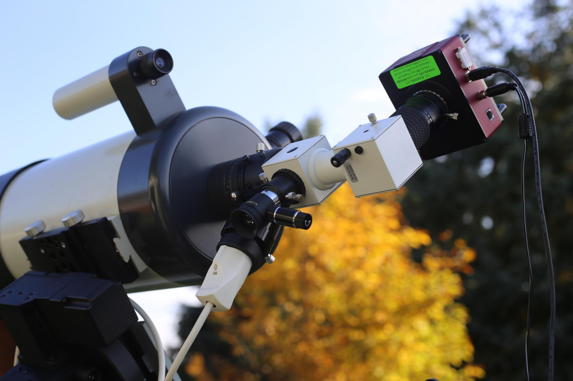
Zeiss-Meniscas 180/1800 mit DADOS-Spektrograph und Gitter 1200/mm sowie CCD-Kamera SBIG STF 8300M und Ne-Kalibrierlampe
