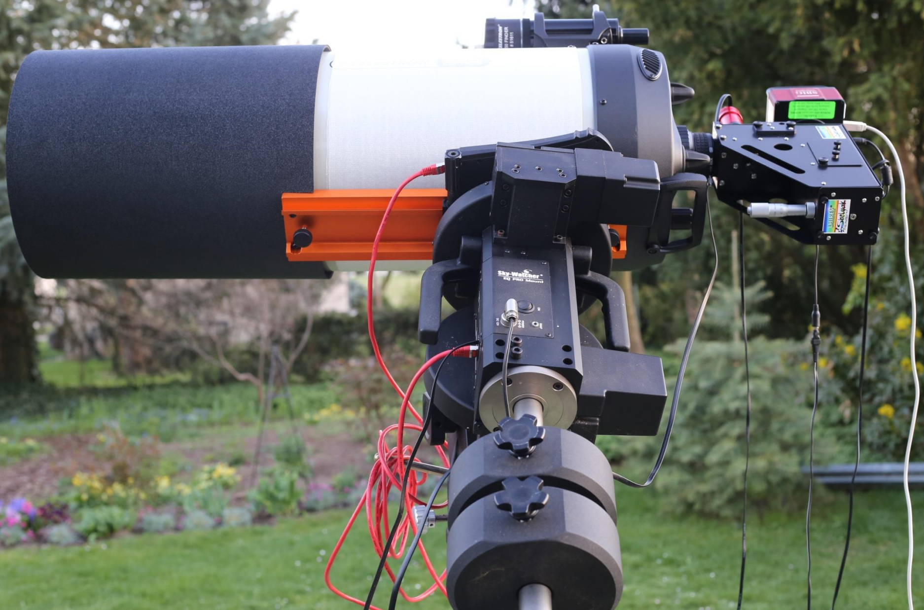
C 11 280/2800 auf EQ 8-Montierung + LHires III Spektrograph + CCD STF 8300 m
